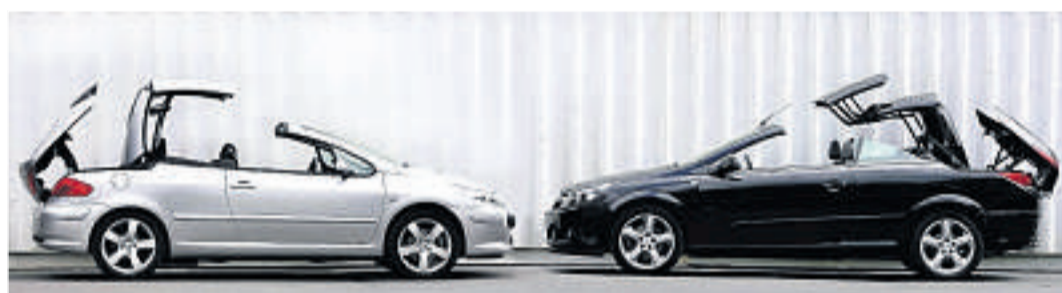
Zwei gegen Drei: Der Peugeot (links) besitzt ein einfaches, zweigeteiltes Hardtop. Der Astra setzt auf drei Teile – das ermöglicht ein flaches Heck.
